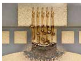
Пережог токоведущей дорожки и перегорание проволочных соединений, ведущих к traversе вывода стока транзистора
