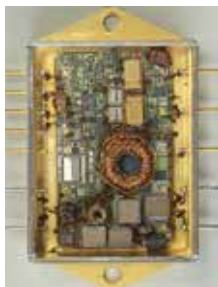
Общий вид внутренних элементов модуля питания
