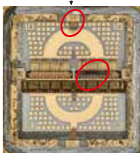
Общий вид элементов конструкции транзистора после демонтажа крышки
