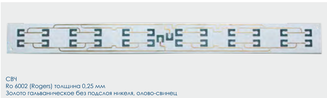
Переходная плата для применения микросхемы BGA с шагом 0,8 мм взамен LQFP с шагом 0,5 мм с металлизированными полуотверстиями
