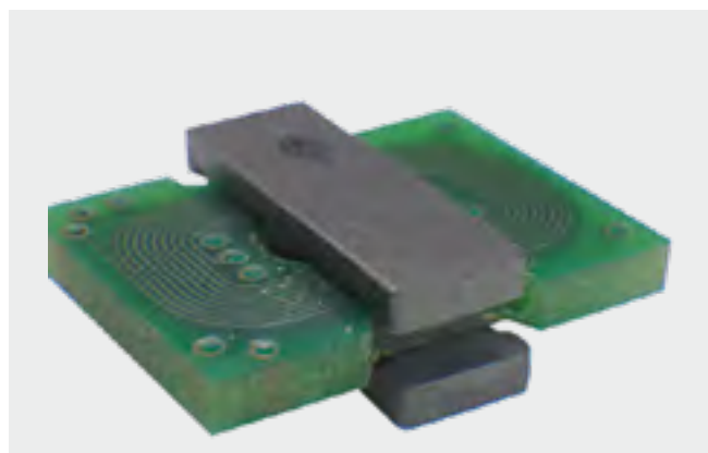
Трансформаторы с обмотками, выполненными на печатных платах Напряжение – до 1000 В Ток обмотки – до 5 А Частота – до 500 кГц
