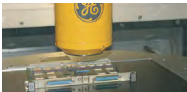
Рентгеновская установка высокого разрешения с функцией томографии Контроль разварки кристаллов Обнаружение трещин в проводниках с размером менее 1 мкм Контроль качества пайки микросхем BGA, CGA и других сложных корпусов Контроль качества лития
