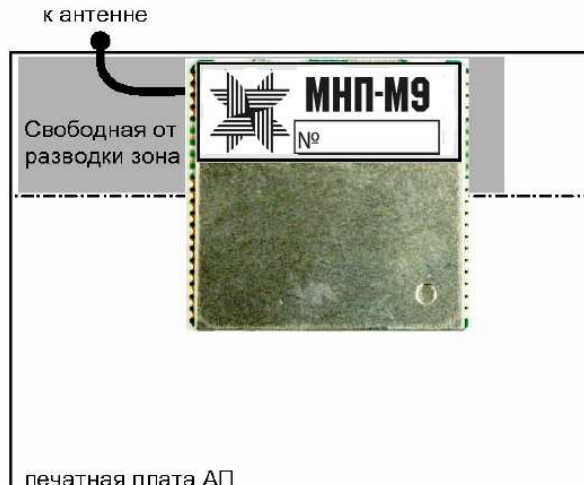
Рисунок 6 – Рекомендуемое расположение приемника МНП-М9.1 в АП
