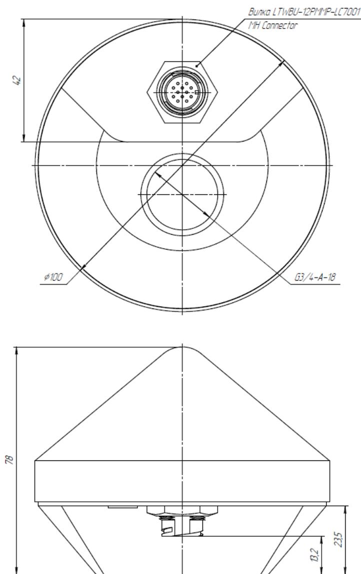
Рисунок 1 - Габаритные и присоединительные размеры БСН
