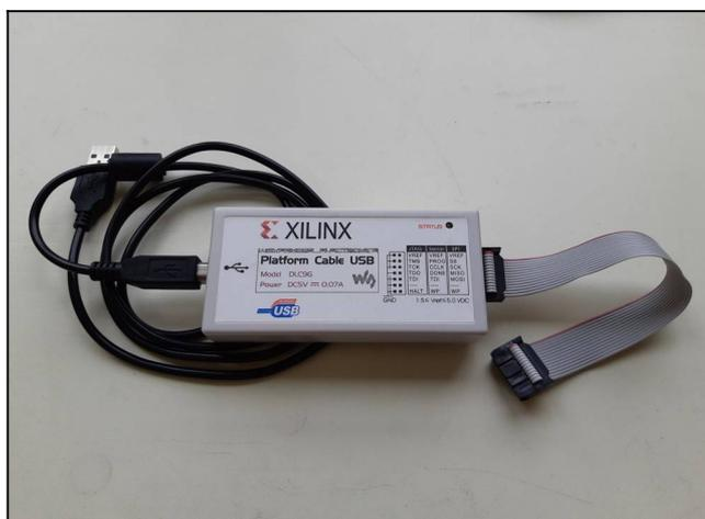
Рис. 3-1 Программатор Xilinx Platform Cable USB
