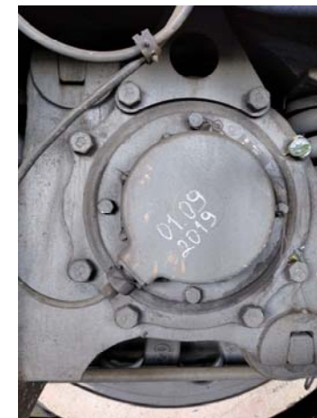
Рисунок Г.4 – Установка датчика вводом кабеля по направлению вниз (правильная установка)
