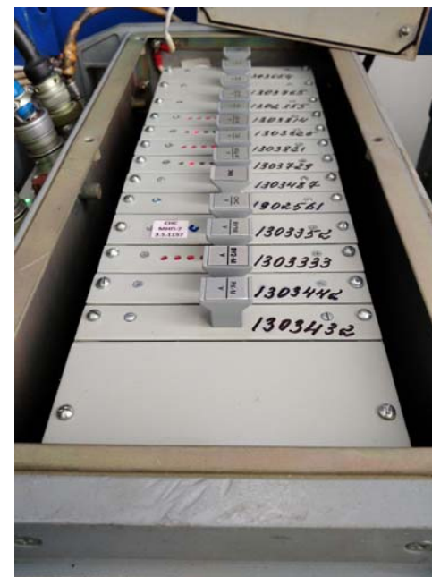
Рисунок Г.12 - Блок БЭЛ-У с установленными и затянутыми ячейками
