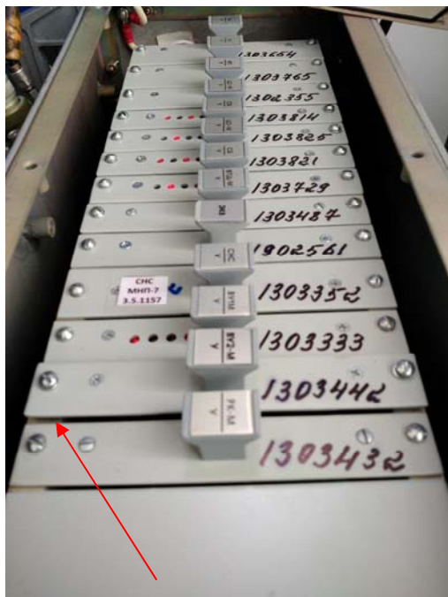
Рисунок Г.13 – Блок БЭЛ-У с недостыкованной и незафиксированной ячейкой
