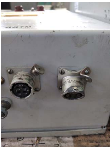
Рисунок Г.11 – Повреждение соединителей блока БКР-У
